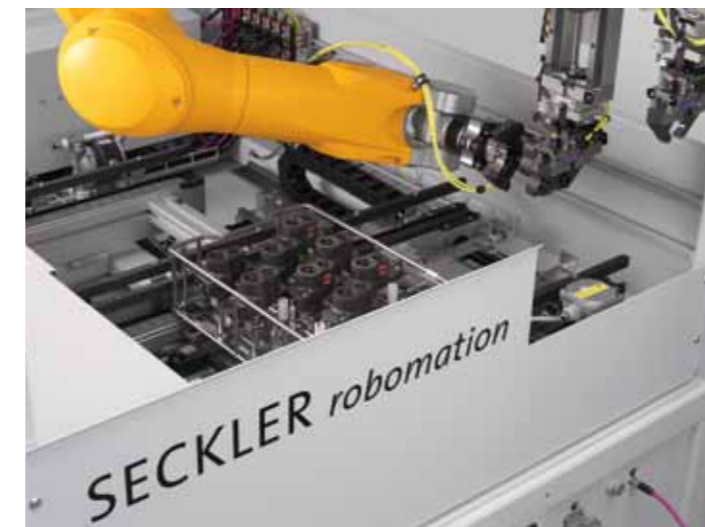
Beide Bilder zeigen die Übergabe des Werkstückes an die Portalachse.
