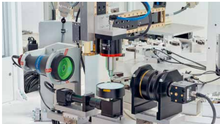
Optische Messung von Durchmessern, Längen, Höhen, Distanzen, Winkeln, Radien und Konturen
