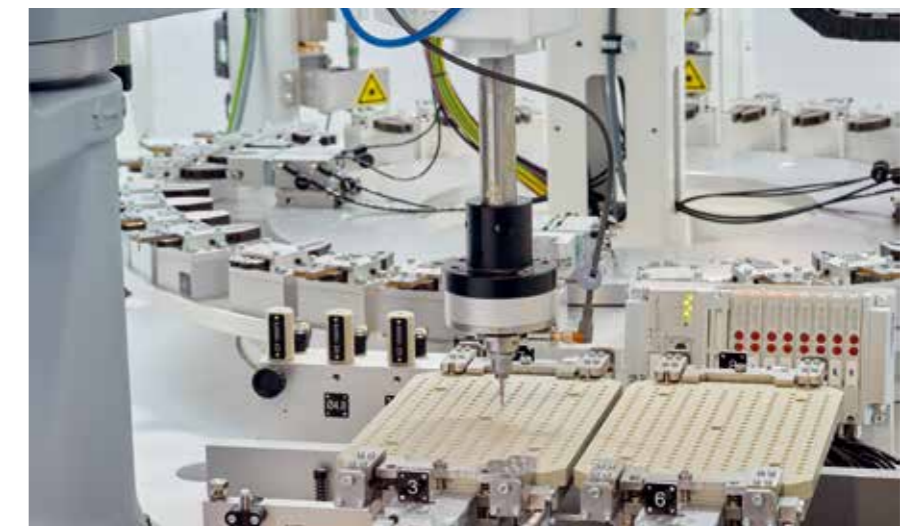
Beispiel einer Werkstückzuführung über Palette und Roboter
