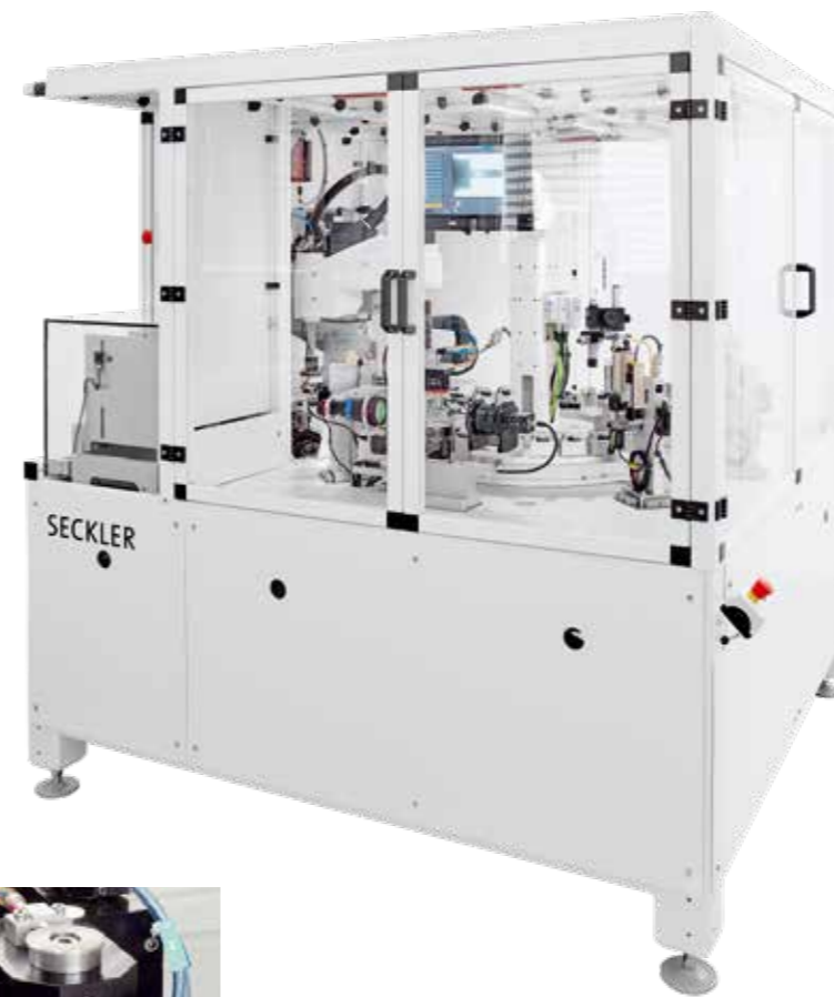
Beispiel einer Werkstückzuführung über Palette und Roboter
