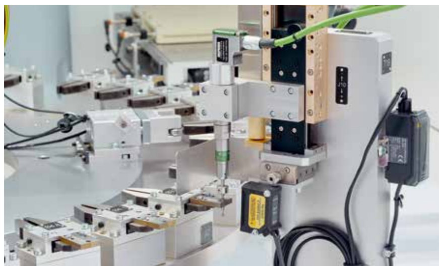
Prüfung des Drehmoments und der Tiefe des Innengewindes
