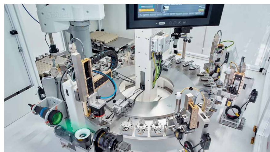
Rundtaktisch mit mehreren Mess- und Prüfoperationen
